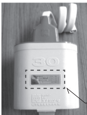
写真2 低圧進相コンデンサ。 [ ]内のプレートが銘板
