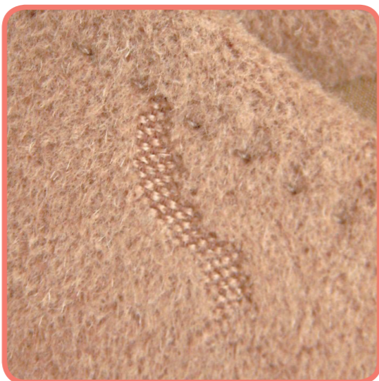
写真2 毛羽のみが消失し、基布が露出している
