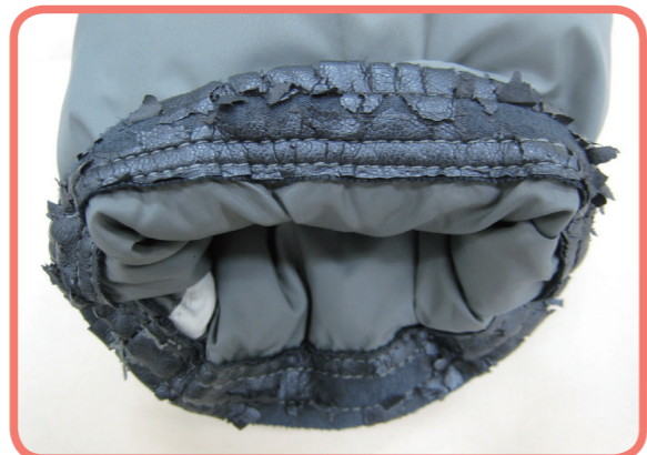
写真2 裾内側、袖口部分などに使用されている合成皮革のポリウレタン樹脂が経時劣化し、剥離している
