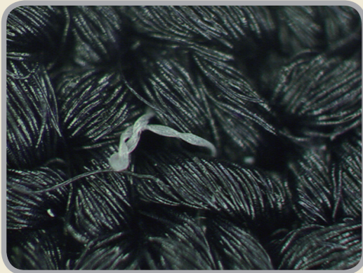
顕微鏡写真 ポリウレタン弾性糸がループ状に引き出されている
