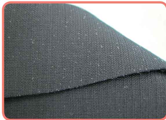
写真2 肩や衿部分にポリウレタン弾性糸が吹き出した状態になっている
