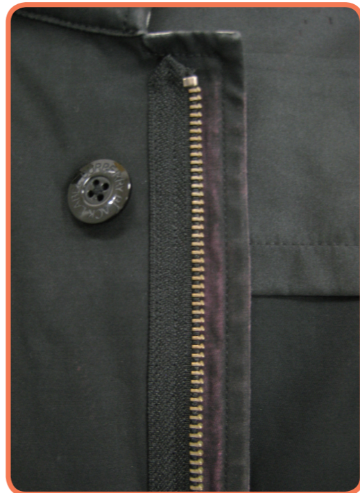
金属のファスナーと接触している部分の生地が赤く変色している
