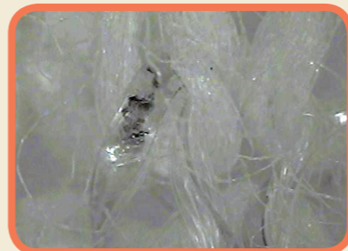
顕微鏡写真 事故部の金属光沢がなくなったスリット糸
