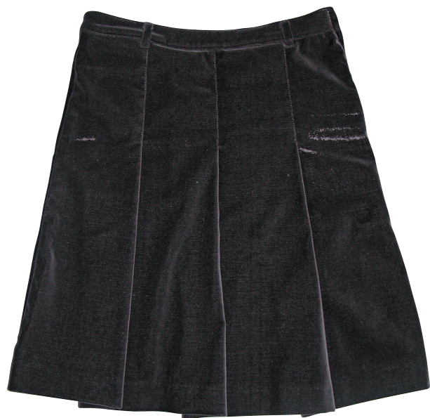
前腰付近両脇部分のパイルが脱落したスカート
