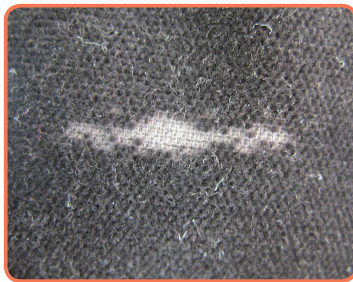
パイルが脱落し、基布が露出している
