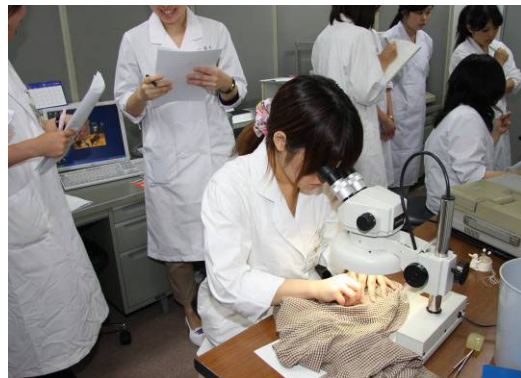
事故品鑑定の実習。顕微鏡で事故部分を拡大して観察
