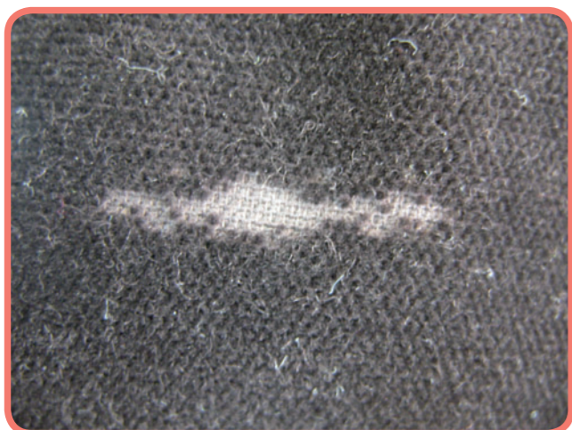
写真2 スカート前側、腰付近の両脇部分でパイルが脱落し、基布が露出している
