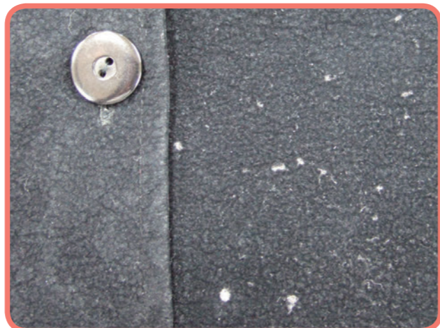
写真2 各所、パイルが脱落して基布が露出したため、穴が開いたように見えている
