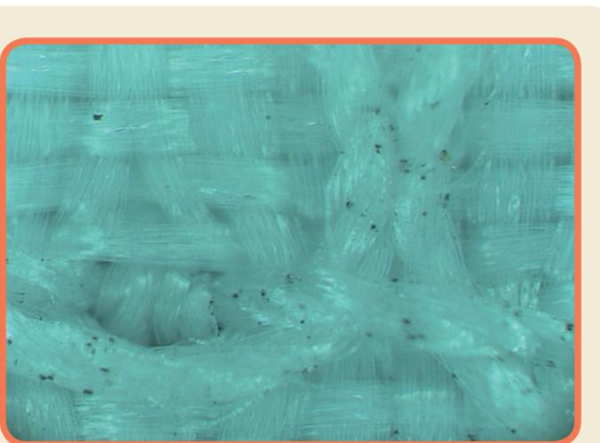
顕微鏡写真 顕微鏡でカーボン状の粒子の付着が確認できる
