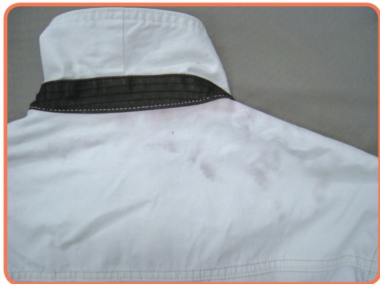
台衿の後ろに部分使いしている茶色の天然皮革から染料が溶け出し、周辺の生地を汚染している
