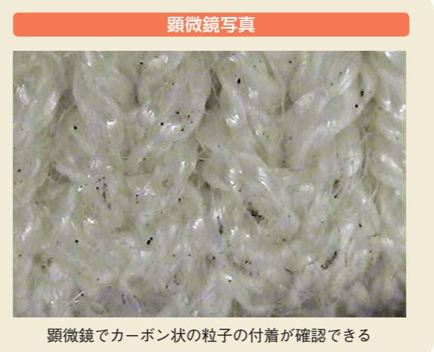
顕微鏡でカーボン状の粒子の付着が確認できる
