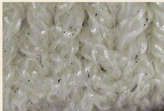
顕微鏡でカーボン状の粒子の付着が確認できる
