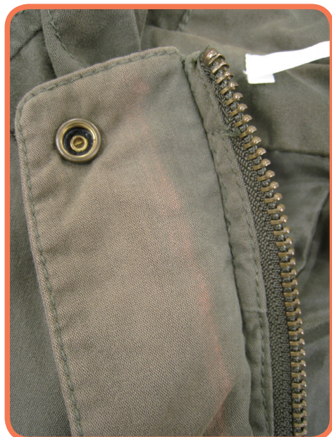
金属ファスナーと接触している部分の生地が 赤茶色に変色している
