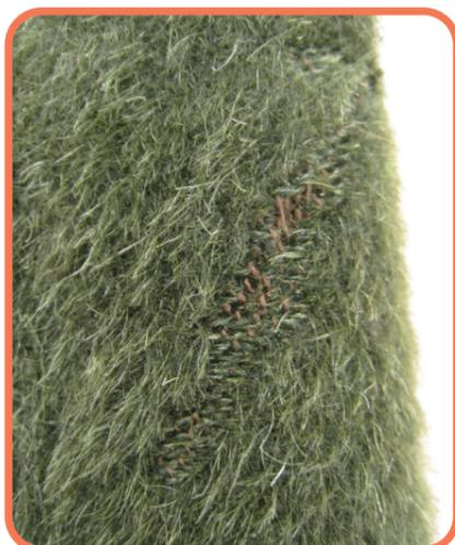
毛羽のみが消失し、基布が露出している
