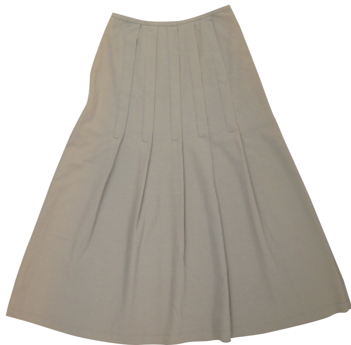
カーキ色のスカート。全体がオレンジ色っぽく変色し、特に両脇や裾の変色が著しい
