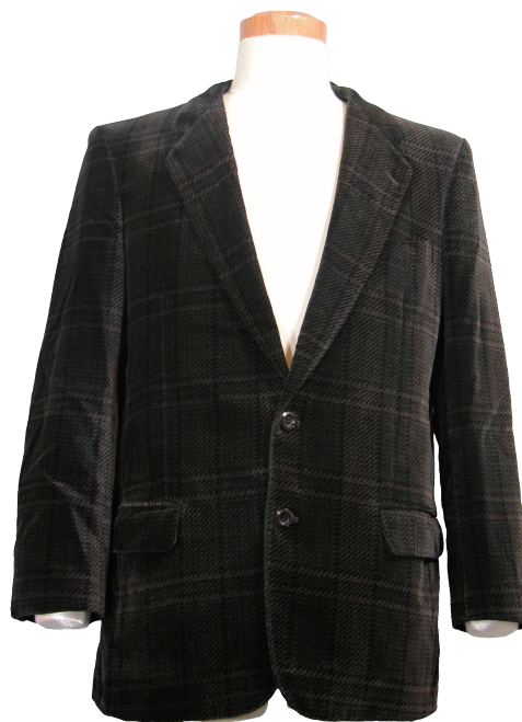
上衿と下衿の縫い目付近のパイルが脱落したジャケット
