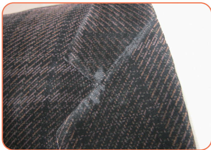
パイルが脱落し、基布が露出している
