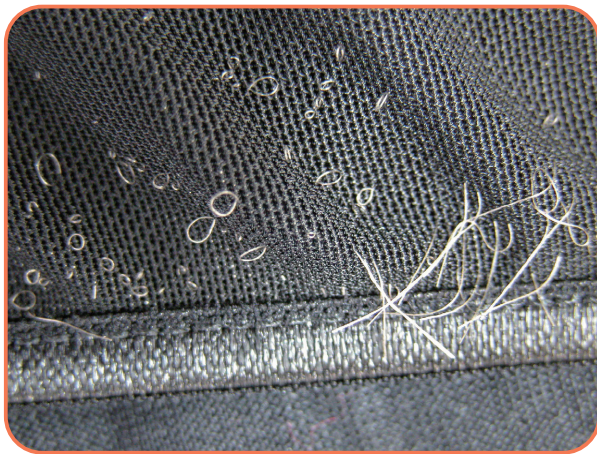
裏地裾部分。ポリウレタン弾性糸が引き抜けて飛び出した状態になっている
