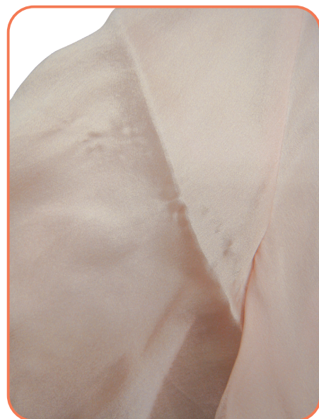
袖付け根部分に波打ちが生じている
