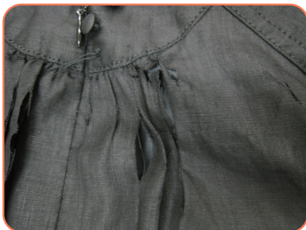
後側上部のファスナー両脇に破損が生じている
