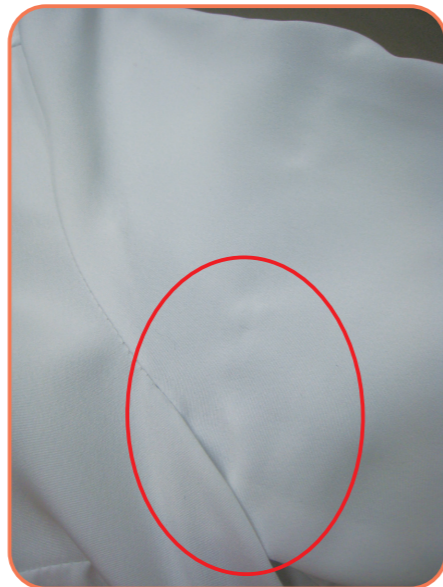
袖の付け根部分に波打ちが生じている
