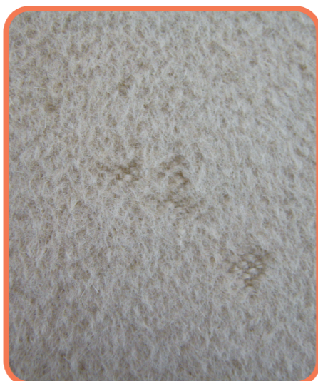
起毛が消失し、キズのようにになっている
