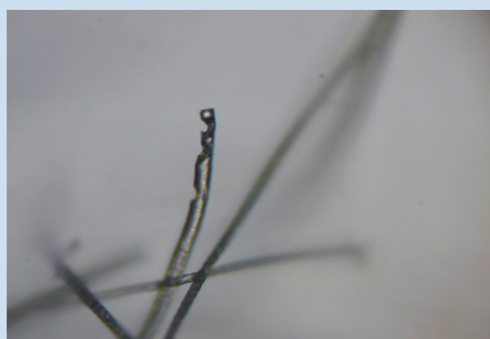
衣料害虫の食害に特有の形状が確認できる
