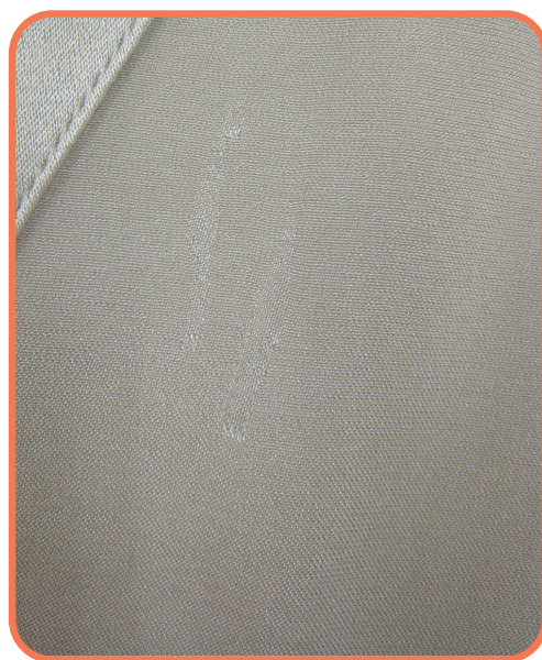
目寄れにより表面が変化している
