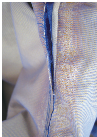
青色の表側生地とグレーの裏側生地の貼り合わせが剥がれている
