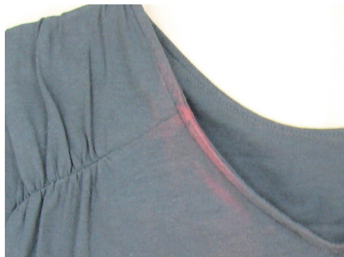
金属に接触する生地表面のみが変色
