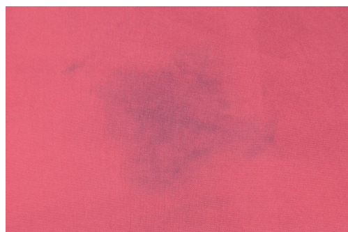
赤系の染色物が金属と反応して変色した例
